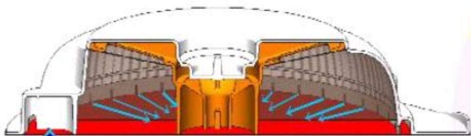
Вода поступает во впускной коллектор, Проходит в круговой водный канал и через тонкие жиклеры впрыскивается в отсек с кофе
