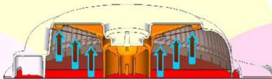
Вода смачивает кофейный порошок протекая через отсек с кофе
