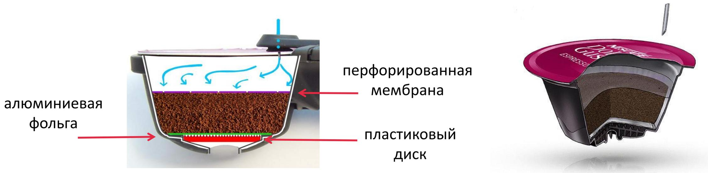
1. После установки капсулы **специальная иголочка прокалывает герметичную крышку капсулы** и вода поступает в капсулу под высоким давлением до 15 бар.
