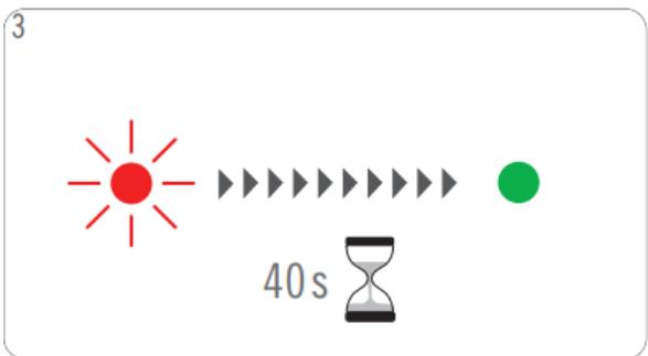
Машина автоматически включается после удаления держателя капсулы. Пока машин нагревается, световой индикатор начинает мигать красным в течении приб. 40 сек. После этого световой индикатор загорается постоянным зеленым светом. Машина готова к использованию
