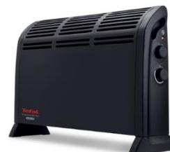
Более тяжёлый холодный воздух поступает в конвектор снизу, нагревается, и выходит через решётку с направляющими створками. Разница плотностей холодного и горячего воздуха создаёт тягу как в трубе.
