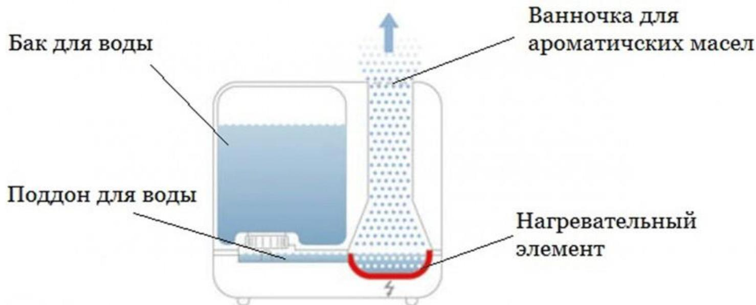
Паровые увлажнители работают по принципу чайника. Вода поступает в изолированную камеру парообразования, кипит, и выходит в виде пара через трубку. При этом температура выходящего пара достаточно высокая – 50-60°C.
