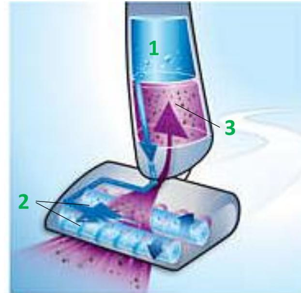
2 емкости: для чистой и грязной воды. Чистая вода подается из резервуара 1, и увлажняет микроволоконные щетки (2) . Прилипшая к полу грязь удаляется за счет размягчения водой и механического вращения электрощетки. При этом вода вместе с грязью всасывается в отдельный резервуар.
