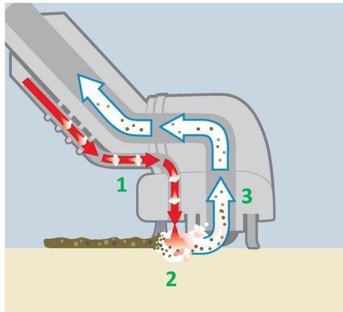
В специальную емкость заливается чистая вода, нагревается и уходит в паровой канал
