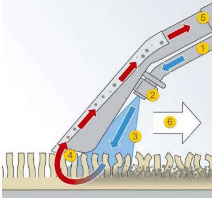
В емкость с чистой воды помещается раствор моющего средства и по трубке (1) подается в распылитель (2) Распылитель под давлением орошает поверхность (3), а всасывающий канал (4) собирает влагу вместе с мусором и через специальный канал (5) собирает грязную воду в отдельный контейнер.
