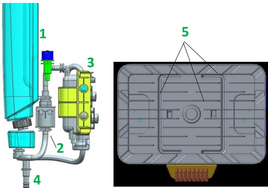
Вода из резервуара 1 с помощью насоса 2 закачивается в трубку, проходит через противоизвестковый картридж и, уже умягченная, попадает на нагревательный элемент 3. Пар поступает вниз, к выходному каналу 4 и распределяется по внешним каналам 5.
